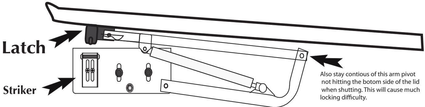
**ENSURING PROPER LATCH ALIGNMENT.**
